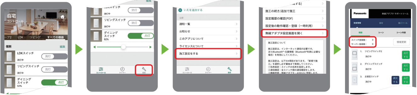
スイッチアプリを開きます。 右下の「設定」を選択します。 一番下の「施工設定をする」を選択します。(確認画面で「はい」を選択) 選択項目一番下の「無線アダプタの設定画面」を選択します。(機器コード「開く」を選択) 「アダプタ設定画面」で登録状態を確認します。
