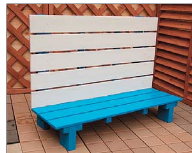
【木材・用具】 杉スノコ(2枚) 2×4材 エゾマツ角材 ハンギング用フック カネジャク メジャー 木ネジ(65mm, 55mm) ドライバビット(下穴あけ用、プラス) サンドペーパー 鉛筆 ハケ 塗料/水性多用塗(ホワイト、スカイブルー) ロングビット(プラス)
