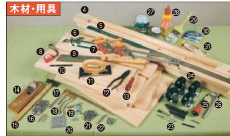
電動工具 ①マルチインパクトドライバー、②インパクトドライバー、③パワーカッター ④木材(2×4 SPF材、ラジアタバイン集成材、ラミン丸棒(直径34)) ⑤モノサシ ⑥ハタガネ ⑦クランプ ⑧メジャー ⑨ノコギリ ⑩鉛筆 ⑪ハンドサンダー ⑫ペンチ ⑬プラスドライバー ⑭カンナ ⑮カナヅチ ⑯チェーン(20×2本、45×2本) ⑰カネジャク ⑱取っ手(幅90×2コ) ⑲ローラーキャッチ(2組) ⑳蝶番(4コ) ㉑木ネジ(38) ㉒ボルト、ナット(70) ㉓ドリライビット(下穴用、木工用) ㉔キャスター(75ゴム車) ㉕ドライバー ㉖ソケットレンチ ㉗水性多用塗料(スモークグリーン、パステルサンド) ㉘木工用ボンド ㉙ハケ ㉚両面テープ ㉛パテ
