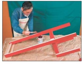
9 ペイントが乾いたら、背面に丸棒を木ネジでとめる。(下穴あけ→木ネジ締め)
