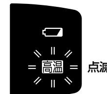
作業を中断し、約30分以上放熱させ、高温お知らせランプが消灯してから使用してください。また、保護機能がくり返し働くような作業は行なわないでください。
