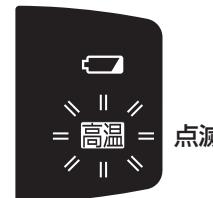
作業を中断し、約30分以上放熱させ、高温お知らせランプが消灯してから使用してください。また、保護機能がくり返し働くような作業は行なわないでください。
