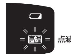
作業を中断し、約30分以上放熱させ、高温お知らせランプが消灯してから使用してください。また、保護機能がくり返し働くような作業は行なわないでください。
