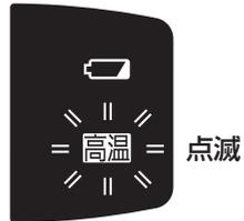
作業を中断し、約30分以上放熱させ、高温お知らせランプが消灯してから使用してください。また、保護機能がくり返し働くような作業は行なわないでください。
