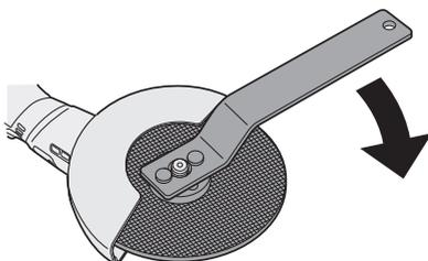
※トイシ外径(φ100 mm)締め付け時のイラストとなっております。
