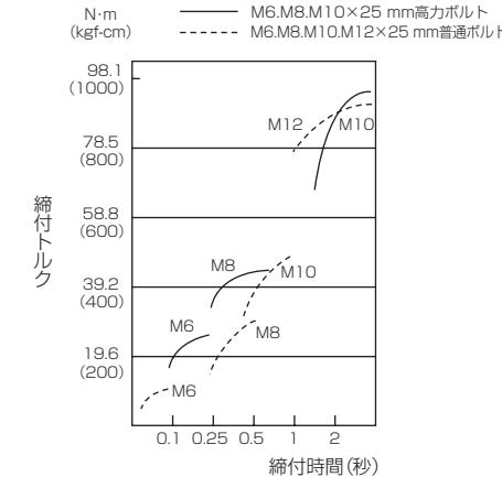
締付トルクは電池パックの充電状態により変化します。下図は締付トルクと締付本数の関係を示した例です。
