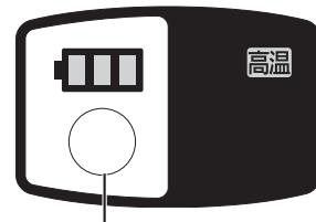
電池残量表示ボタンを押すと約10秒間電池の残量が3段階で表示されます。
