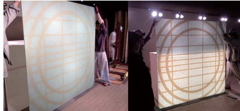
左：2×2mの和紙入り合わせガラス。右：ライトアップの実験。
