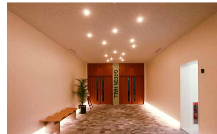
GREEN HALL 前の廊下。LED電球ダウンライトはGREEN HALL へ向かって疎から密に変化させた。
