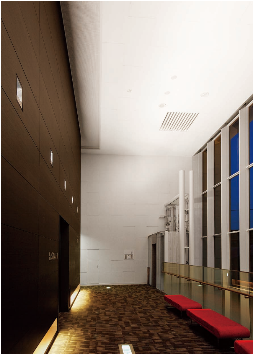
2階ホワイエロビー：左の壁面に天井を照らすシーリングウォッシャーを設置。タイルカーペットの床面にはフットライトの柔らかな光が伸びる。
