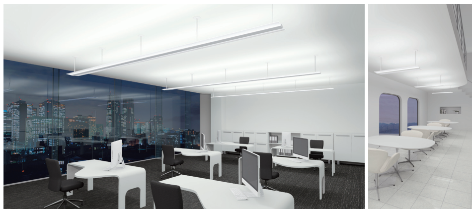
左右：パナソニックのシミュレーション技術「リアルCG」を用いたイメージ。天井面に光が広がっている。取り付け間隔が広い（25頁、図2参照）、設置器具台数の削減が可能。
