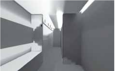
基準階男性トイレ。Feu値：9.5、平均床面照度：128 lx。シミュレーション画像提供：パナソニック電工
