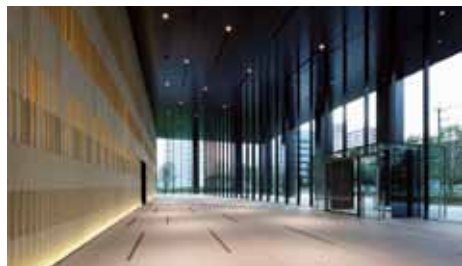
エントランスホール。壁面のテラコッタから暖色系アッパー照明による柔らかな光が漏れ植栽の緑や自然光と混じり合う。*1
