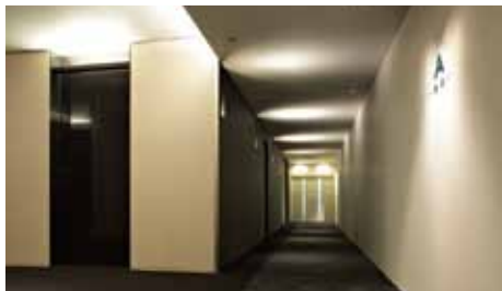
基準階廊下。壁面に仕込まれたLED照明が天井と壁面を照らす。完成後のFeu実測値：8.75。*1
