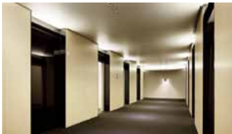
基準階エレベータホール。天井を照らすことで効率的に明るさ感を得ている。完成後のFeu実測値：11.9。*2
