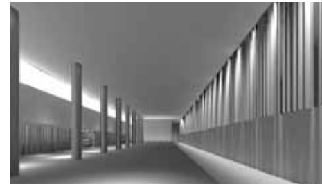
エントランスホールの照明計画シミュレーション。 Feu値：2.8、平均床面照度：127lx。
