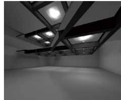
格子状の梁間の中央にダウンライトを設置する検討案CG。ダウンライトだけが明るく、全体的に明るさ感が不足している。Feu値：1.0、平均床面照度：26.3lx。
