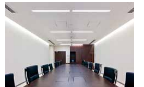
4階会議室。コーニス照明で壁面を照らし、明るさ感をアップさせている。
