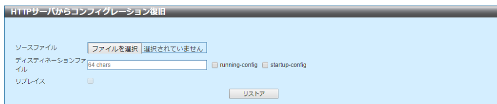
図 14-10 HTTP サーバからコンフィグレーション復旧
