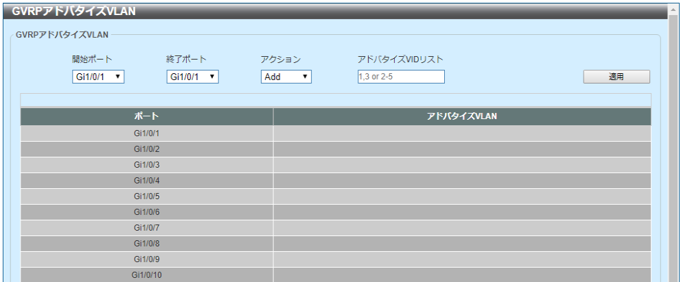
図 4-14 GVRP アドバタイズ VLAN
