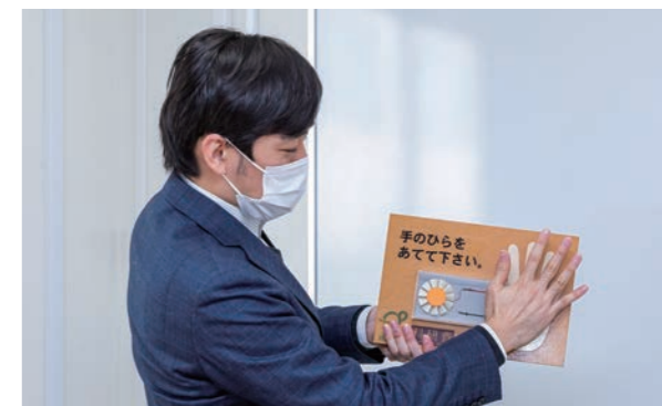
熱電変換技術を説明するデモンストレーション。板の右側に貼り付けた熱電変換モジュールに手のひらを当てると、体温により温度差が生まれ、電気が発生。その電気を利用して、左側のファンが回る。
