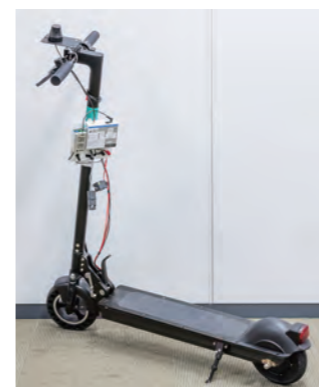
2019年8月より東北大学青葉山新キャンパス内で、東北大学、NICHe、民間企業の産学共同で、遠隔給電の最新システムを導入した電動キックボードの実証実験を実施中。松木教授がプロジェクトリーダーを務めている。
