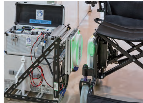
電動車椅子へのワイヤレス給電をデモ機で実験。約30cmの距離まで離れても充電が可能で、バッテリーを充電する作業がとても楽になる。
