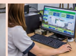
中央監視システムWeLBA。様々なメーカーの設備を組み込むことができ、ビルの設備を一元管理できます。
