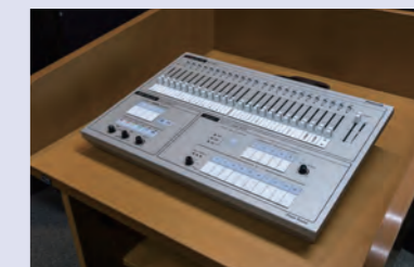
記憶調光操作卓「バスタルバレット」。カラーLED照明器具のカラーコントロールが一般の方でも簡単に操作できるバレットタイプをご採用。
