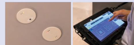
左:マルチマネージャEx 右:設定操作用タブレットEx 1万通りの調光調色の組み合わせが可能で、作品の微妙な色味を忠実に再現します。作品ごとに最適な当て方を、学芸員の方々が自ら設定を行います。操作方法は工事会社様や代理店である山陰パナソニック様がレクチャーされました。
