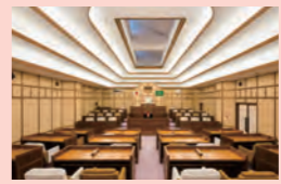
庁舎内に併設されている議場は間接照明をLED化。資料が読みやすく、落ち着いた空間に見える3500Kを採用。
