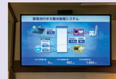
発電量モニター
