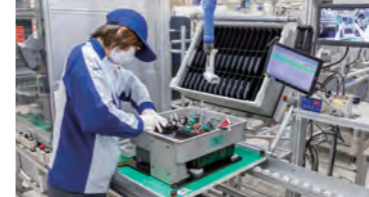
パワーコンディショナ本体組み立て中の様子
