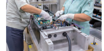
V2Xスタンドを組み立てている様子
