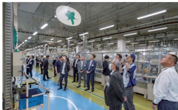
組立後は、天井付近のベルトコンベアを通り検査・梱包工程へ
