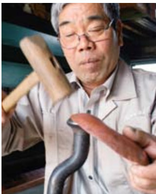
何度も焼き、叩く。「打ち出し」「絞り」と呼ばれる工程。銅板に丸みをつける大きな釘は「エボシ」という。
