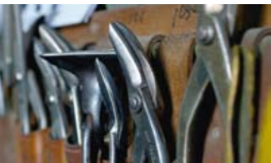
銅板の厚み、用途でハサミを変える。刃が反った形の小さいハサミは「エグリ」、大きいのは「ヤナギバ」。
