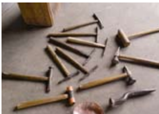
木づちと金づちは厚みや丸みをつける角度などによって使い分け、銅板のひずみを取る。
