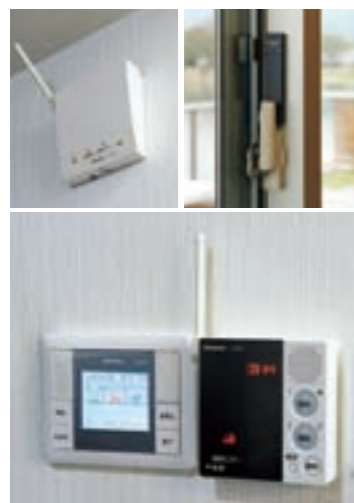
「ライフィニティ」の小電力型ワイヤレス中継器 (上左)、窓ガラス用センサー (上右)、コントロールパネル (下左) とワイヤレスセキュリティ受信器 (下右)
