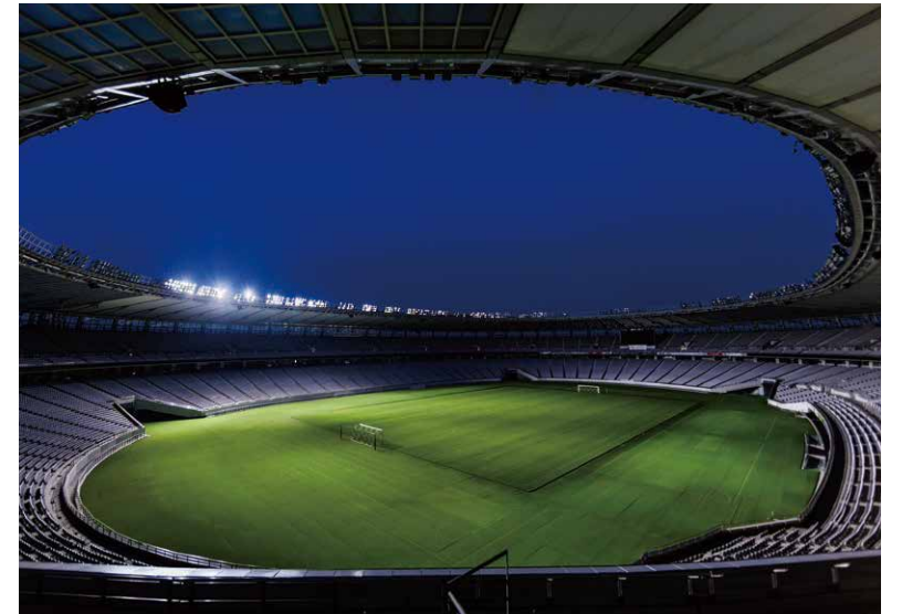
競技に合わせた照明パターンの切り替えが可能。LEDならではの瞬時点灯や0～100%のシームレスな連続調光も実現
