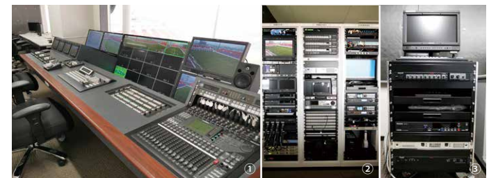
①映像を見ながら直感的な操作が可能なスイッチャー ②映像制御・送出装置 ③移動卓のライブスイッチャー
