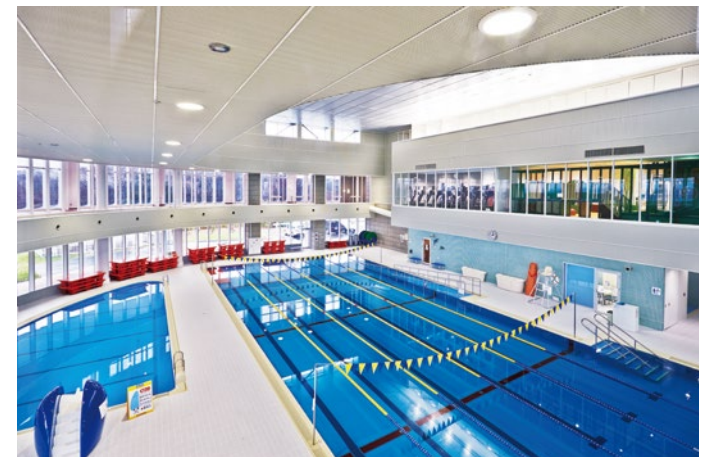
屋上階キャットウォークから天井を照らすことで柔らかな光環境をつくり出している温水プール
