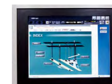
タッチパネル採用の照明制御システム
