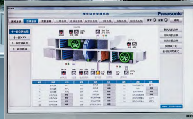
②防災センターの中央監視卓 ③防災センターに設置されているiopeNet盤 ④エリアごとに空調制御を統合するICONT ⑤空調制御システムの管理画面
