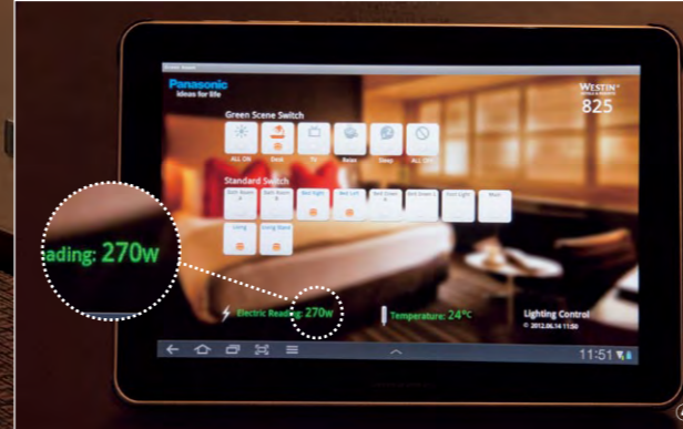
②おやすみモードの照明シーン ③デスクモードの照明シーン ④照明を消すとリアルタイムで消費電力量が変化する
