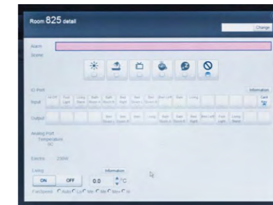
サーバにアクセスすれば各部屋の電気設備の 使用状況監視やコントロールも可能
