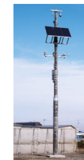
今回の津波より高い7mに設置された大曲海岸の津波監視システム
