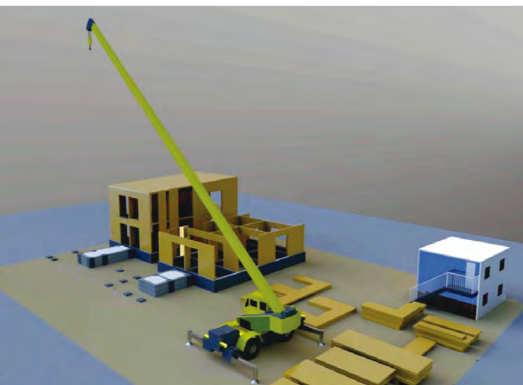
BIMによる施工シミュレーション
