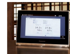
住宅機器コントローラーのモニターで、電力や空気質も「見える化」
