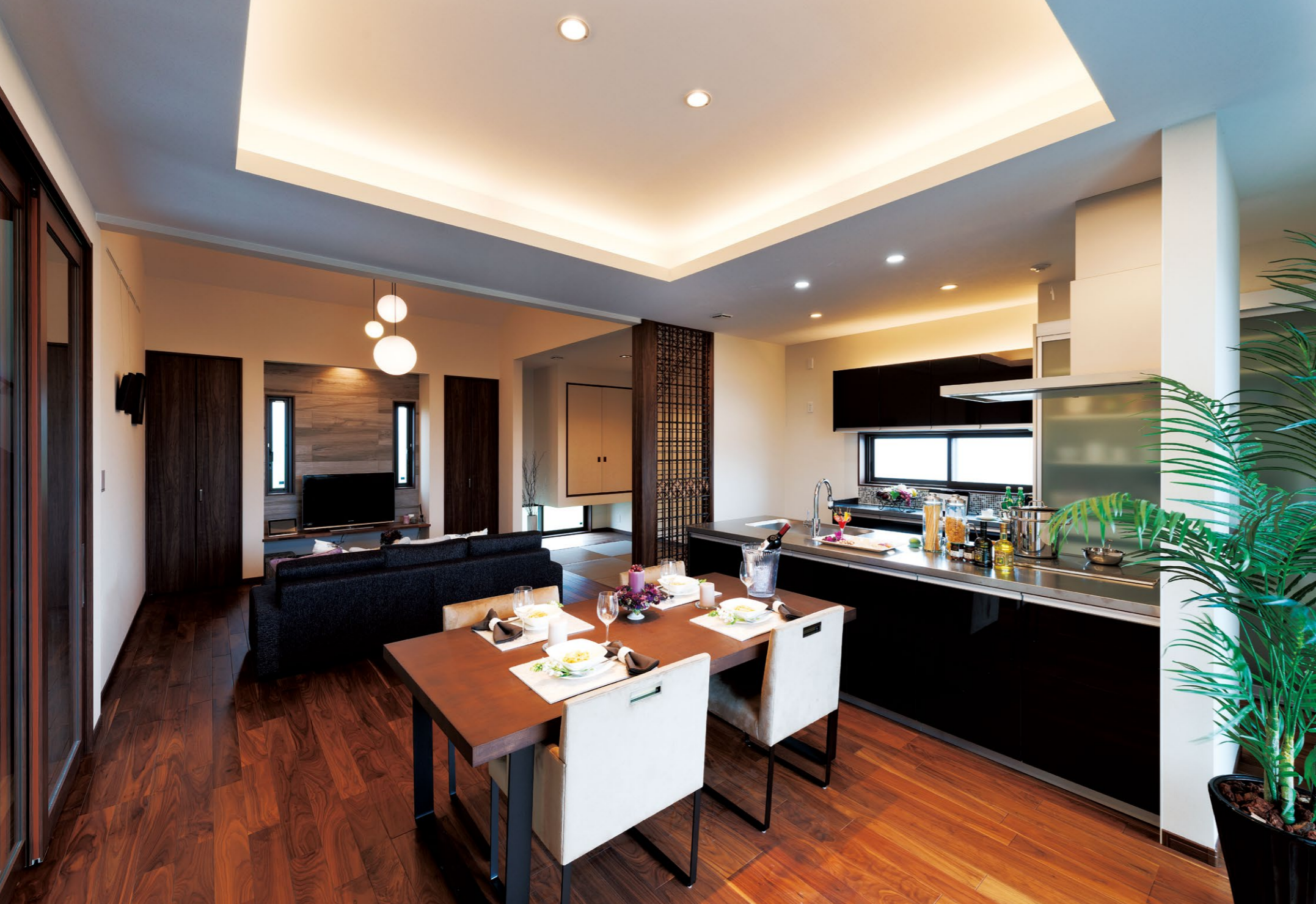
掘上天井やキッチンボード上部に配した建築化照明や多灯ダウンライト、モディファイ・スフィアが配されたダイニング・リビング
