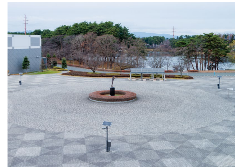
ソーラー街路灯は相互に920MHzのマルチホップ通信で結ばれており、災害や通信トラブルに強い
