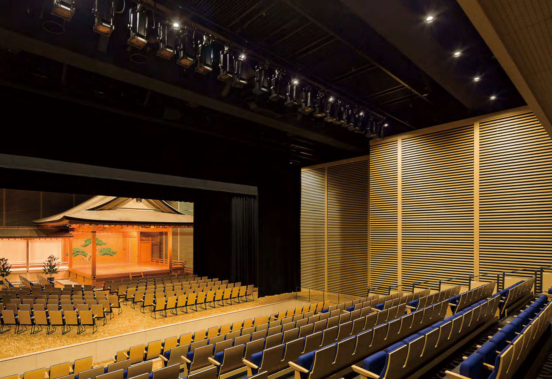
伝統芸能からコンサート、パーティまで、多目的に利用できるように調光タイプのLEDダウンライトが設けられている
