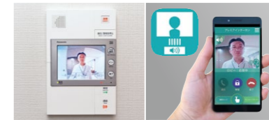
マンションIoTシステム(専用アプリケーション)で、スマホでも来客応答が可能 ※画面は実際と異なります
