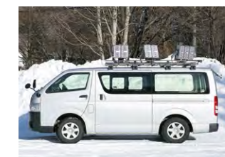
投光器と蓄電池を搭載した照明車
