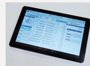
マルチ調光調色システムが容易に操作できるタブレット
