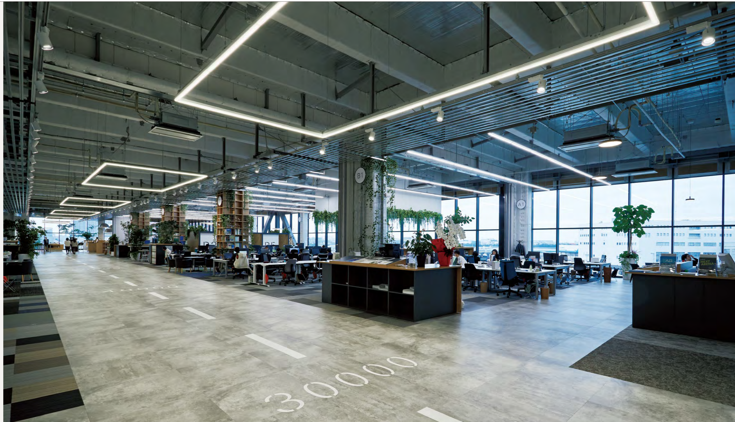
100mの長さがあるランウェイでは、TOLSOスポットライトにフランネルレンズを装着することで光を拡散し、エントランスから奥のカフェまで続く光の絨毯が演出されている
