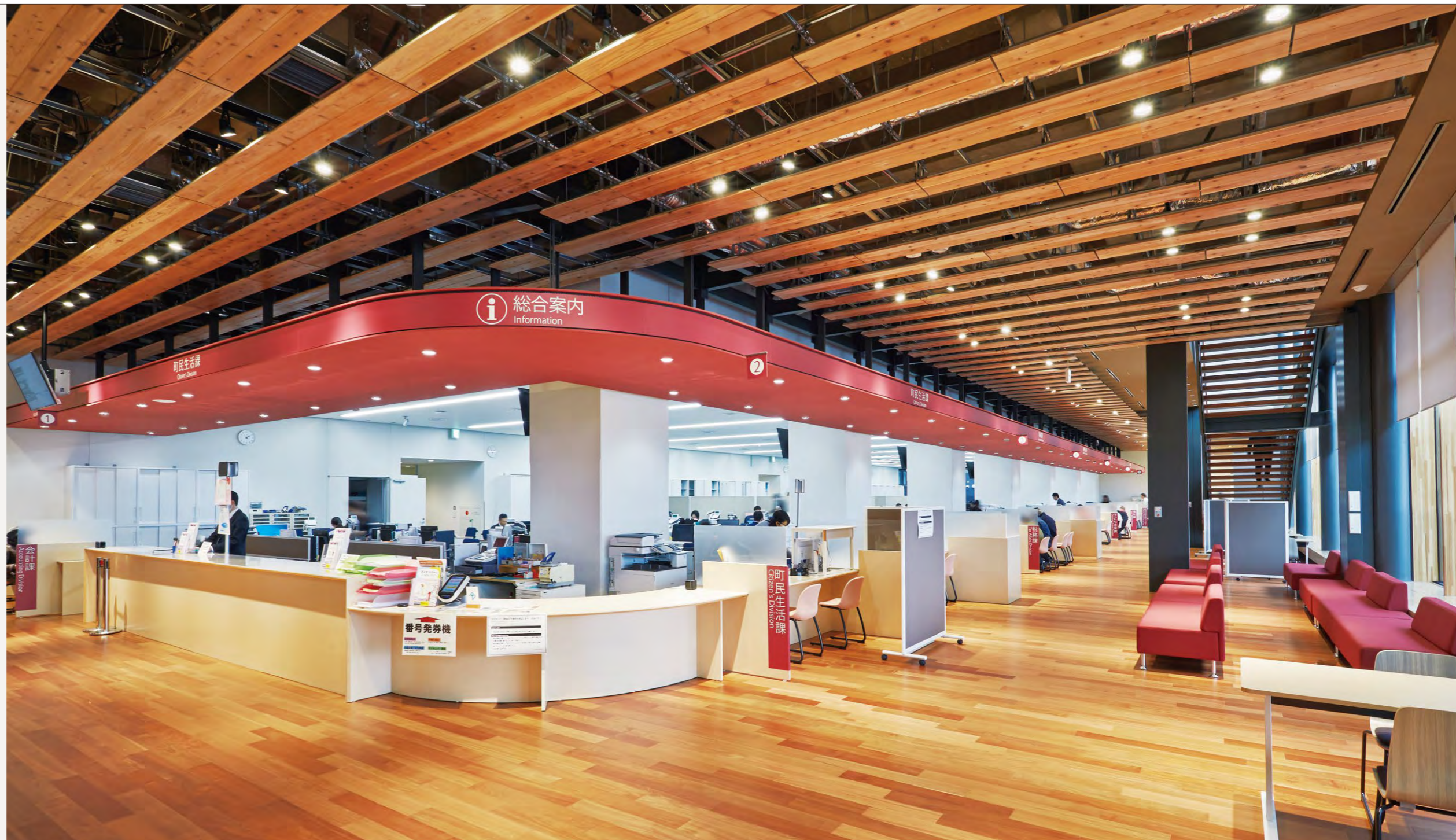
町民を迎えるエントランスは暖かい光色を採用。業務エリアでは色温度が高く設定されている
