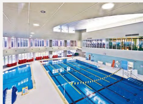
屋上階キャットウォークから天井を照らすことで 柔らかな光環境をつくり出している温水プール
