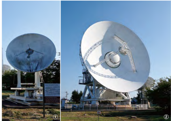
①1987年、直径3.3mのパラボラアンテナによって目で見える光学観測から星の電波を受信する観測方法へ。②国立天文台水沢VLBI観測所の直径20mの電波望遠鏡。
