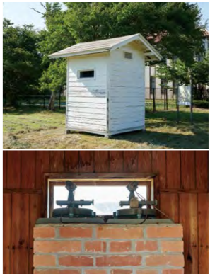
目標台。北を正しく知るために内部に豆球を点灯、眼視天頂儀室から測定した。
