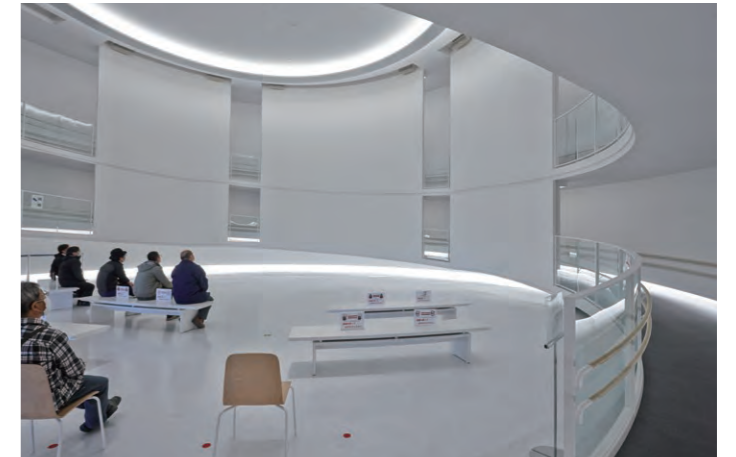
2層吹き抜けのプロローグシアターに設置された巨大な環状の間接照明
