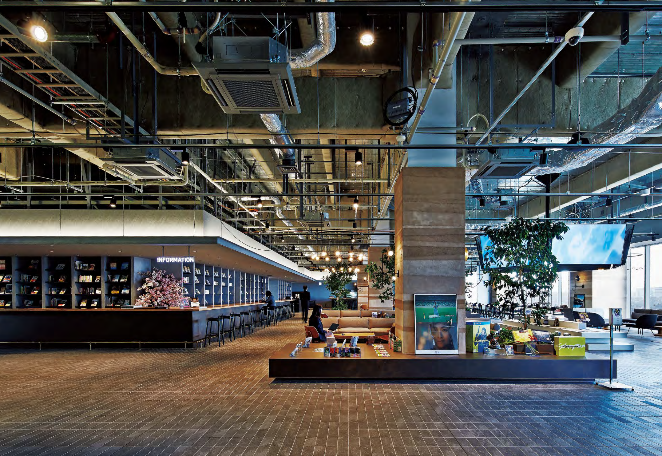
カフェとライブラリーが設けられたエントランス。フロア全体はスケルトン天井に配線ダクト照明が設置されている
