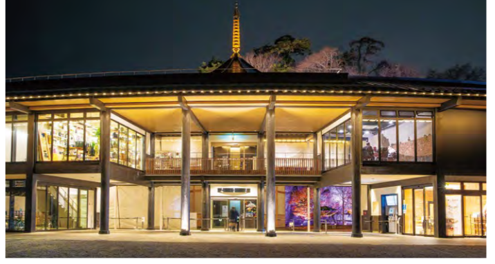
グレアスタウンライトと小型投光器により柱を際立たせているファサード
