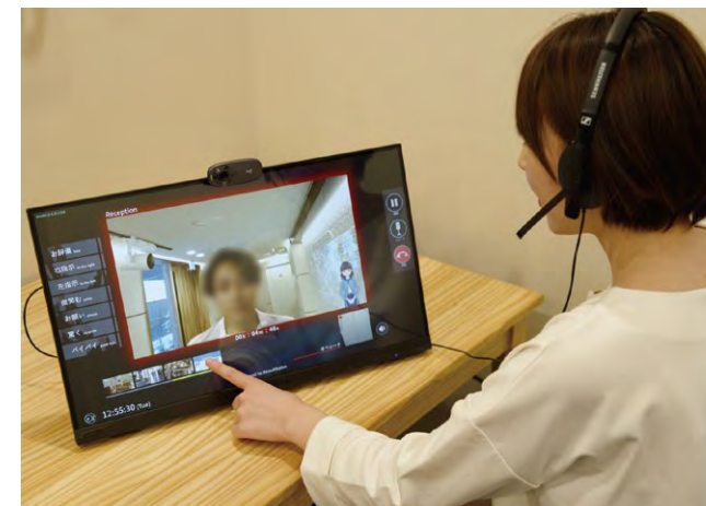
利用者のようすを確認しながら対話するオペレータ。アバターはオペレータの動きと声・しぐさに連動する
