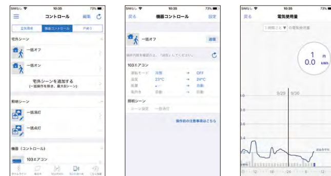
チェックイン・アウト時の各部屋の電力一括オン・オフが可能
