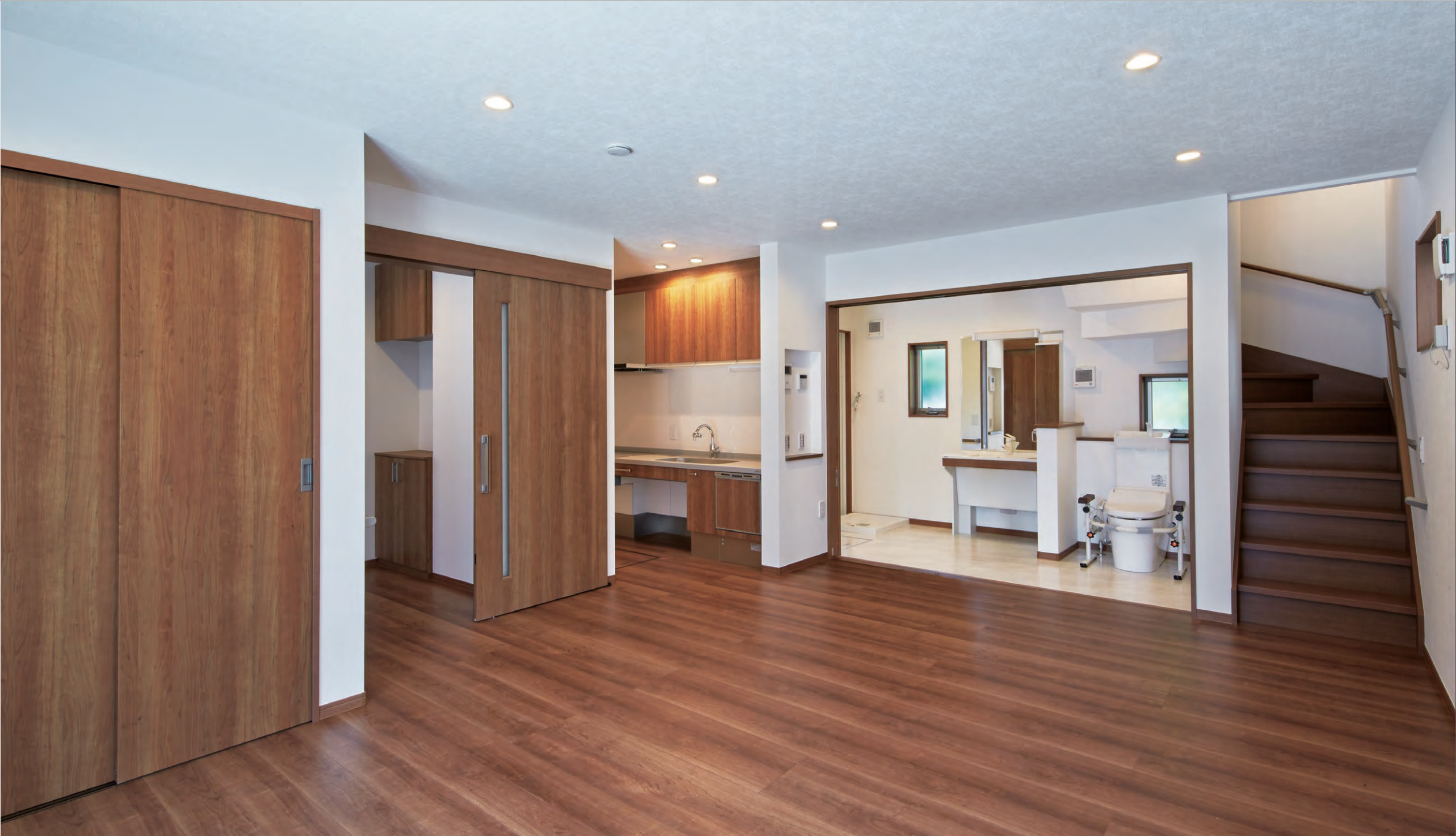
玄関とキッチン、バス・トイレが面した1階リビングルームには、車いすのわだちが残りにくい木質床材 ベリティスフロアーSが用いられている
